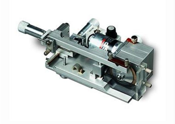
MS3 型マイクロソーは、コンパクトなダイヤモンド砥粒ホイール付で、小型のためステレオ顕微鏡下に簡単に設置することができます。特に、TEM 試料プリパレーションに必要とされる硬質材料の切断用に設計されています。バックラッシュを低減した正確なヘリカルドライブトレインを採用し、0.01mm の精度で正確で再現性のある切削を可能にします。ダイヤモンドホイールの切断速度は連続的に調節可能です。試験片は、調整可能な固定アームとダウンストップ制御機構で容易に切断ステージに取り付けられます。ダイヤモンド砥粒ホイールと切断位置あわせのための簡単操作の調節機構が付いています。ダイヤモンド砥粒ホイールには、発熱を抑えるための冷却リザーバーが付いています。
