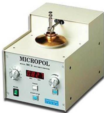
MC3型マイクロポールは、TEM サンプルのグラインダー、ファイン研磨、ディンプルング、薄片作成用に設計された、コンパクトで電氣的に制御された精密機械研磨装置です。研磨パラメータ（速度、負荷、時間）は、特定の試験片および材料の要件に従って調整することができます。高品質のサンプル処理が容易に行えます。MC3 マイクロポールのアームは、試験片を適度な研磨材料を含む研磨ボールに軽く押し付け、半ランダムな幾何学的パターンで動かします。研磨材料は、グラインディングペーパー又は研磨剤を含む研磨布が使用されます。この多用途なMC3 マイクロポールには、平らな研磨ディスク、平面サンプルのためのサンプルホルダーおよびディンプル用試験片のための球形ボウルが付属しています。ボウルは、クイック交換バヨネットマウントを使用して迅速に交換することができます。MC3 マイクロポールには、ボウルと消耗品スターターキット（Ø44mm 研磨紙 240 および 400 グリット、研磨布、ダイヤモンドペースト 1 および 10µm、熱可塑性ワックス）が用意されています。
