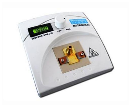
MH4型マイクロヒートは、コンパクトで熱安定化されたホットプレートで、サンプルを埋め込み、ステレオ顕微鏡下で使用可能な熱可塑性接着装置です。コンパクトで薄型のユニットは、電子顕微鏡用の断面試料にとって重要な気泡のない埋め込みおよび接着を可能にします。ホットプレートの温度は広範囲に調整することができ、±5°C以内に保たれます。実際の温度はMH4型マイクロヒートのLCDディスプレイに表示されます。設定温度には、通常、1〜3分以内に到達します。
