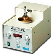
MC3 型マイクロポール TEM サンプル精密研磨装置
